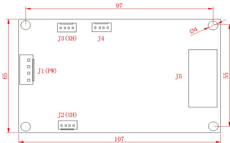
图 2.2 BL2000-HXJ-V9 尺寸图 (单位 mm)
