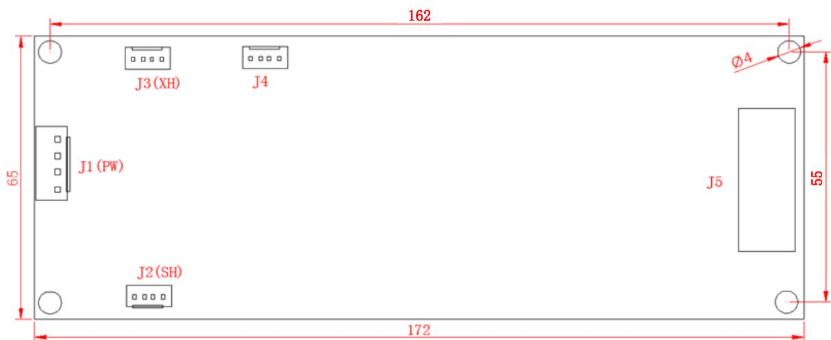
图 2.4 BL2000-HXK-V9 尺寸图 (单位 mm)
