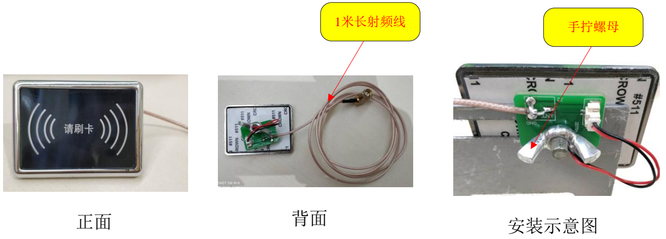
图 2.2 电梯轿厢端控制器读卡头实物图
