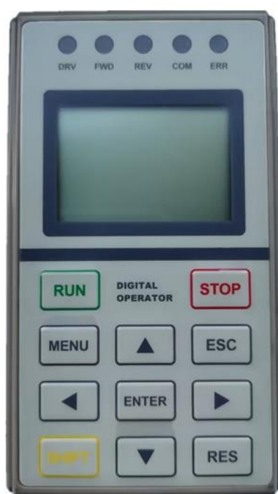
图 4.1 数字操作器外观示意图
