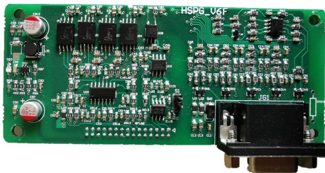
图 2.18 HSPG_V6F 卡外型示意图
